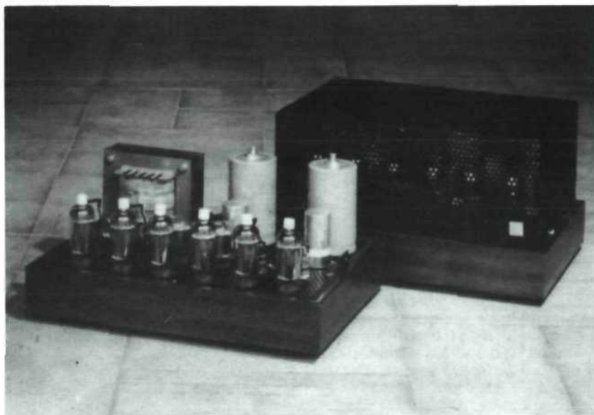
Etapa de potencia a válvulas sin transformador de salida Dr. Klimo OTL. Este producto se sitúa en el área del High End.
